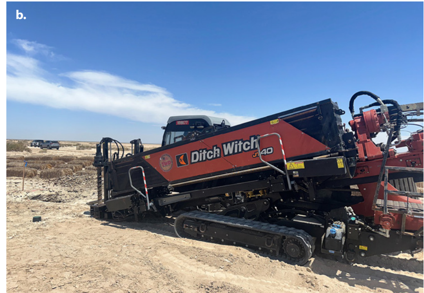
Figura 8. Fisonomía del sitio y actividades en el sitio de West Bombay Beach. a) Instalación de tubería para el sistema de riego por goteo. b) Uso de perforación direccional horizontal para instalar la red de riego. c) Germinación de siembra en plántulas jóvenes sobre las líneas de riego por goteo. d) Crecimiento de la vegetación plantada sobre las líneas de riego por goteo.
