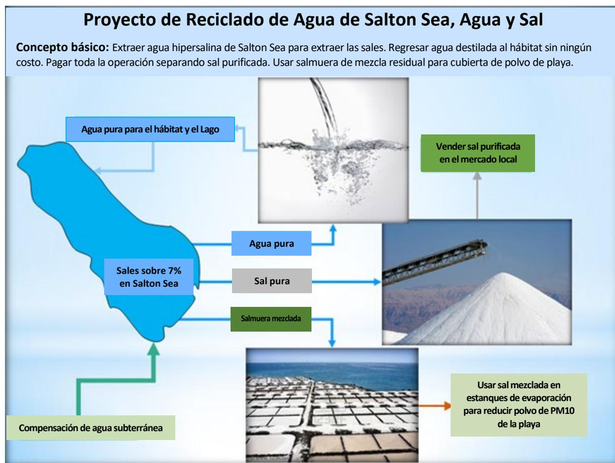
Figura 5-29. Ilustración del Concepto 7: Reciclado de Agua de Salton Sea, Gráfico de Sephton Water Technology.
